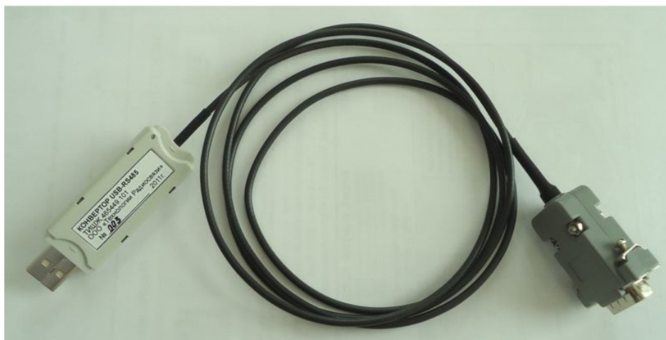
Рисунок 8 – Внешний вид преобразователя интерфейса USB - RS485
